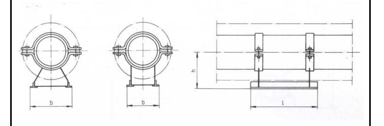
Rohrschlitten mit zwei Rohrschellen vom Typ RS 200 inklusive Schrauben.
