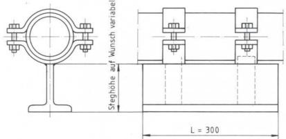
Rohrschlitten mit zwei Rohrschellen vom Typ RS 200 inklusive Schrauben, die Steghöhe kann auf Wunsch geändert werden.
