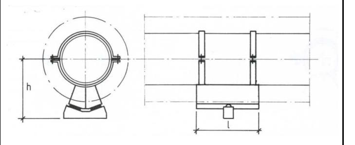
Spezial-Rohrschlitten mit zwei Rohrschellen vom Typ RS 200 inklusive Schrauben.
